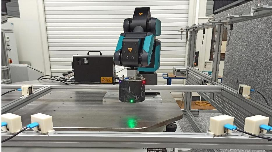
Bild 1: Minimalsetup zur Erfassung der Lage des Roboters
